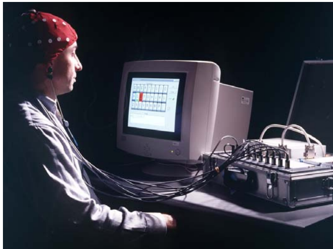
Figura 1. Interfaz cerebral no invasiva para la comunicación. El usuario lleva un gorro con electrodos incorporados (los discos blancos) apoyados sobre el cuero cabelludo y que, con la ayuda de un gel conductor, mide el EEG en diferentes regiones corticales. El usuario selecciona letras del teclado virtual y escribe mensajes. El teclado está dividido inicialmente en 3 partes, una por cada tarea mental que la interfaz puede reconocer, que se dividen en bloques más pequeños a medida que el usuario las selecciona.
